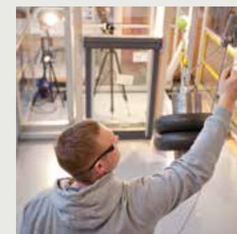
I vetri sono testati per resistere a un carico di 50 kg.
