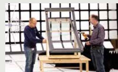
Test sulle potenziali fonti di interferenza elettromagnetica.
